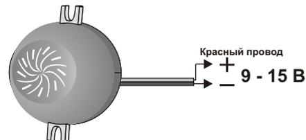
Рис.2 Схема подключения ПКИ-1.
